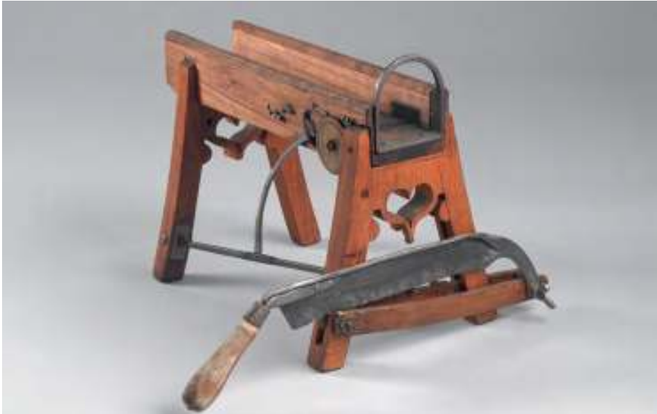
Schneidegerät aus dem Jahr 1769, mit dem die Tabakblätter auf die gewünschte Länge geschnitten wurden.
